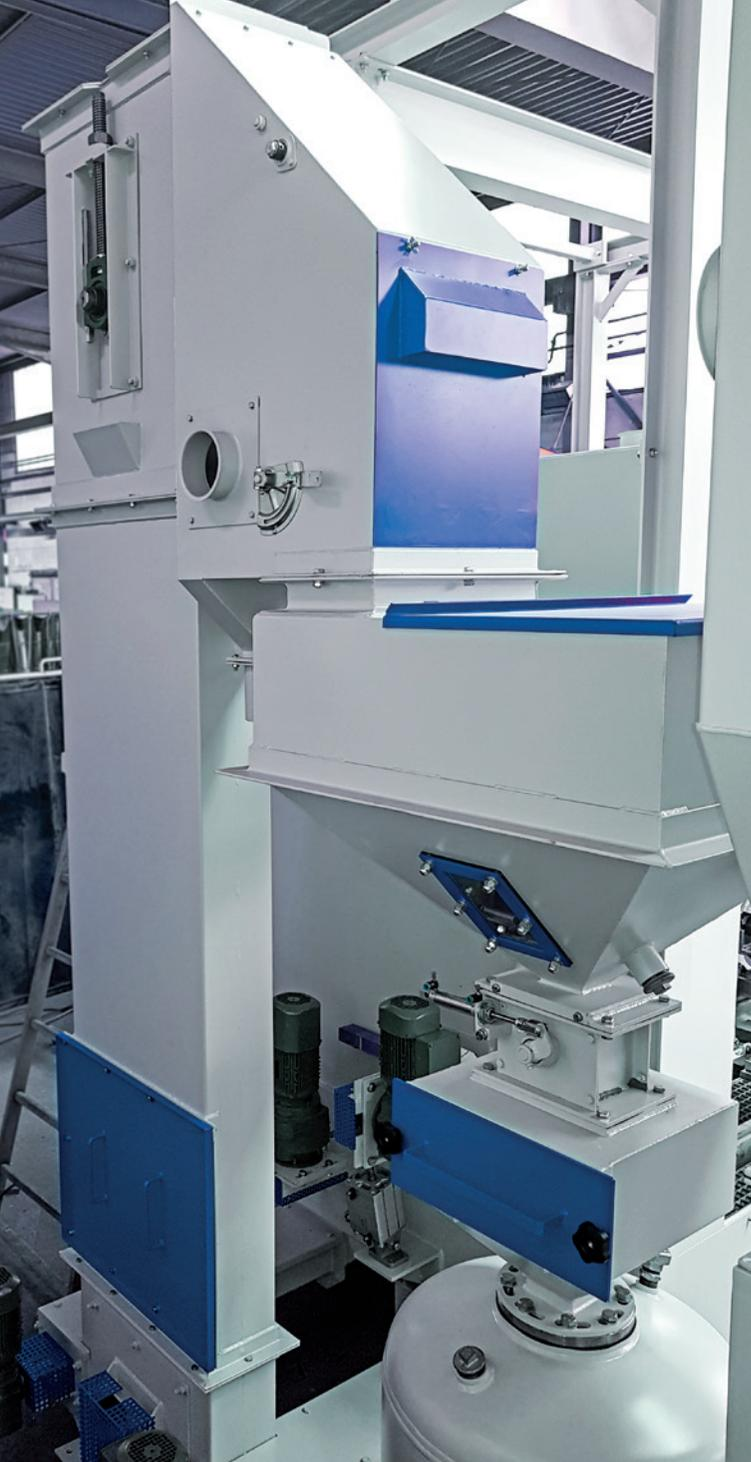
Flachförderboden, Förderschnecken, Becherwerk, Windsichter, Bunker, Strahlmittelnachfüllung, Freistrahldruckgebläse
