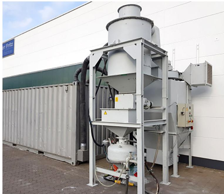
Strahlmittelrückführung durch Zyklonabscheider
