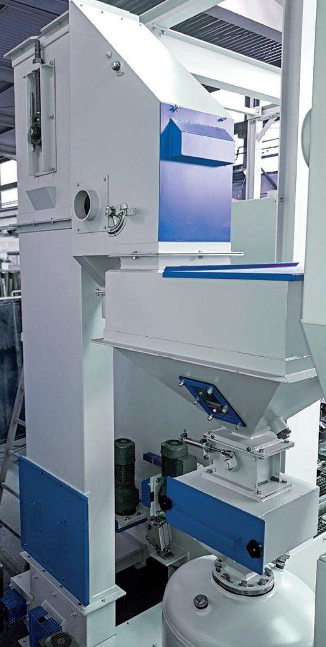
Flachförderboden, Förderschnecken, Becherwerk, Windsichter, Bunker, Strahlmittelnachfüllung, Freistrahldruckgebläse
