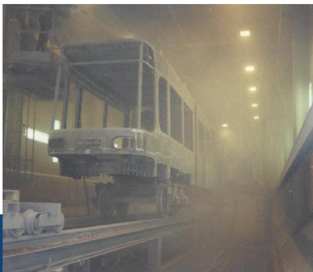
Waggonstrahlanlage in Betrieb
